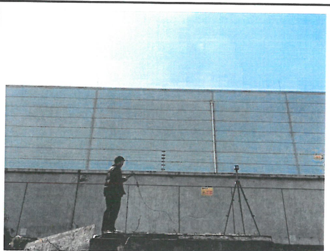
科智 220kV 变电站 110kV 科天线出线侧电磁环境监测
